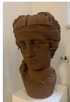
Термопластичен композит от корк и желатин за 3D печат, изследователски проект „GreTA" / рециклируеми базови конструкции за театрална скулптура, изработени от суровини с природен произход
